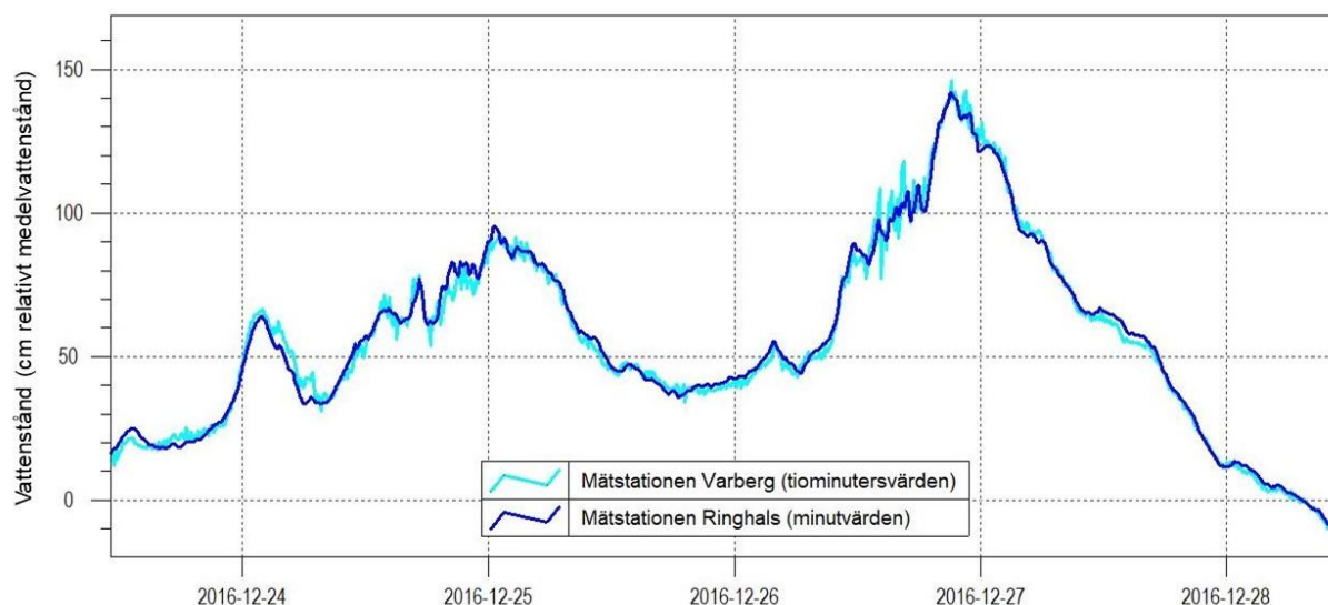
Figur 3. Vattenståndet vid Sjöfartsverkets station i Varberg och SMHIs station i Ringhals under julen 2016.
