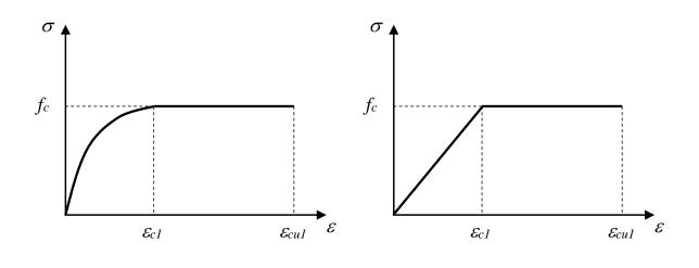
a) Parabola-rectangle diagram. b) Bi-linear diagram.
