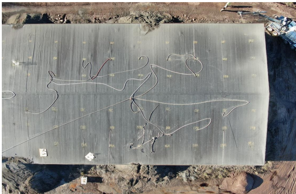
Figur 4. Delar av koordinatsystemet som användes för dimspikar och termoelement. Foto: Räddningstjänsten Östra Skaraborg
