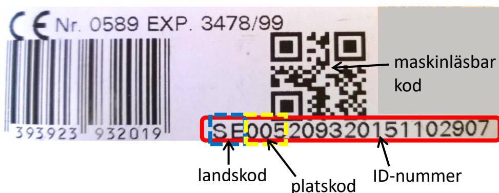
Exempel på identitetsmärkning av explosiv vara (krut)
