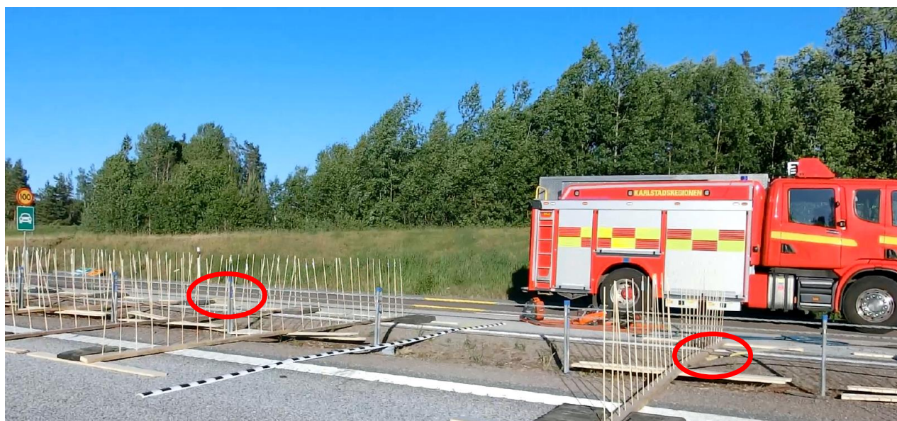
Figur 3 Läge på vajerändar efter Test 01a.
