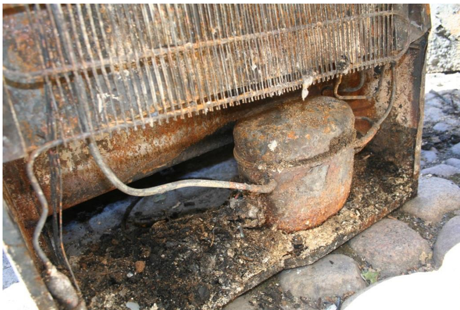
Bild 19 Kompressor, bränd men sammanhållen
