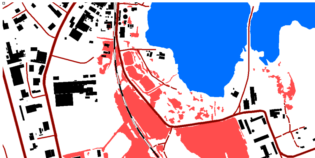
Figur 6: Översvämningskarteringen kan visa potentiellt instängda områden (röda i figuren). Information finns också vid vilken vattennivå som området rent topografiskt kommer att översvämmas samt olika marknivåer inom det potentiellt instängda området. Det som är mörkblått är Mälaren vid +0,90. Mer information om potentiellt instängda områden återfinns i avsnitt 2.4.
