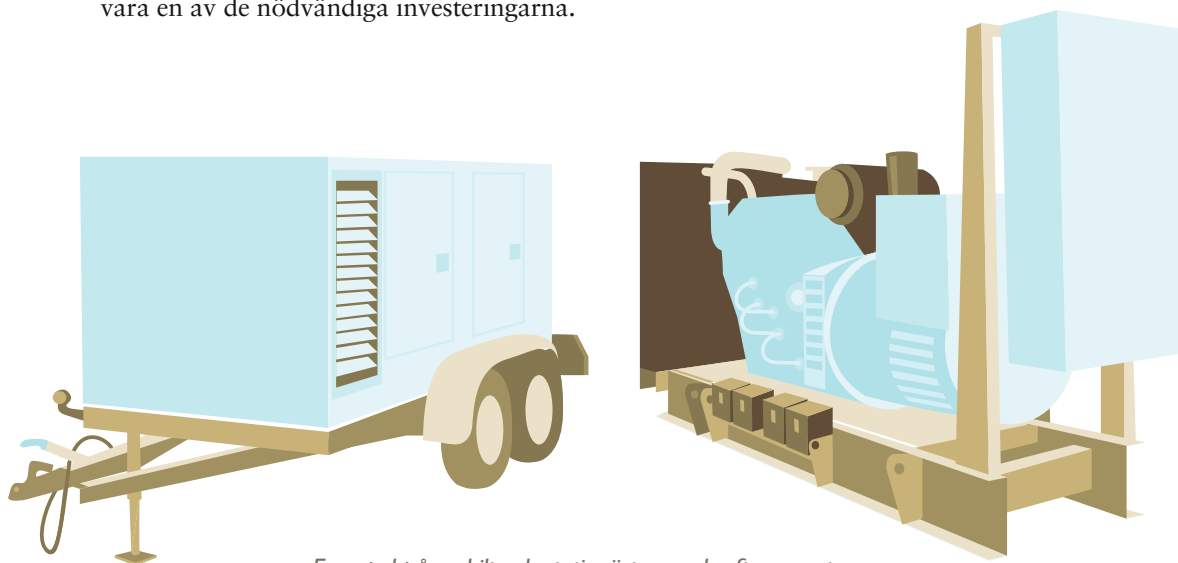
Exempel på mobilt och stationärt reservkraftaggregat
