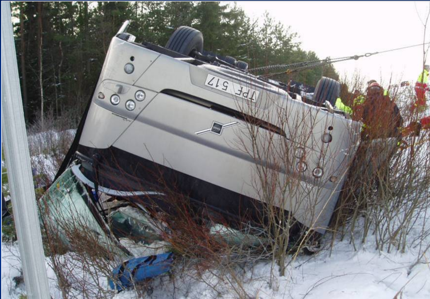
Arboga 2006 – taket intryckt – mycket svår räddningsoperation
