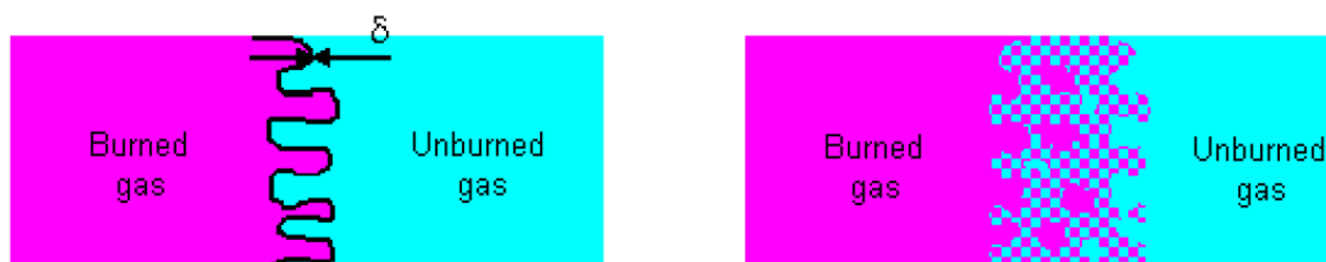
Figur 2.1 Schematisk illustration av veckad flamfront vid turbulent flöde. Från Gexcon (1992).
