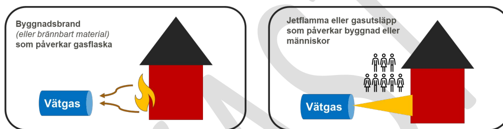
Figur 1. Skyddsavståndet bestäms både av en brand i omgivningen och ett utsläpp på anläggningen.
